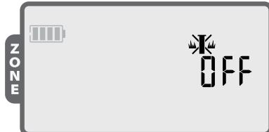
Odabir načina **ISKLJ. (OFF)** otkazat će sve aktivnosti zalijevanja i sprječiti automatsko pokretanje navodnjavanja.
